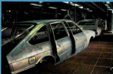
2. Phosphatation au fer: protège des chocs et de l'écaillage et améliore l'accrochage du film de résine dans le bain cataphorétique. Certains corps creux sont lavés et phosphatés avant l'assemblage de la caisse.
