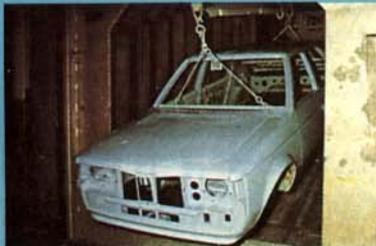
6. Apprêt: le support de la laque renferme des pigments inhibiteurs de rouille (chromates de zinc) qui améliorent encore la protection anticorrosion. Cet apprêt spécial souple comporte également une fonction antigravillonnage.
