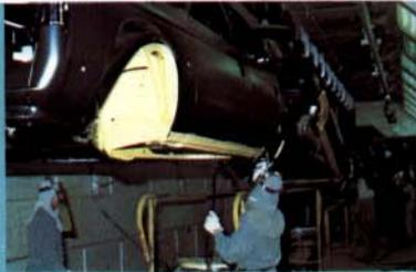
5. Revêtement plastique (PVC) cuit au four: protection des parties de la caisse soumise au gravillonnage (épaisseur: environ 1 à 2 mm).
