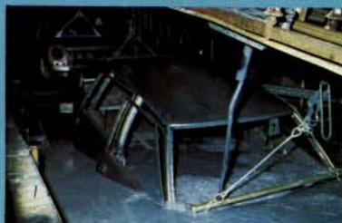
3. Bain cataphorétique: dépôt d'un film de résine "Epoxy" anticorrosion de 15 à 20 microns sur l'ensemble de la carrosserie. Les corps creux sont ajourés pour permettre une protection des surfaces internes.
