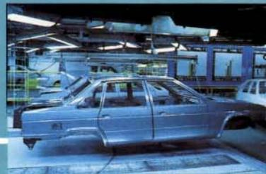
7. Laque acrylique NAD (non acqueuse dispersion): elle est thermodurcissable à la cuisson au four au-delà de 150° et son pouvoir gommant est élevé grâce à une rapide évaporation des solvants.
